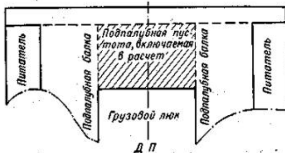
Рис. 4.2.5.1 Схема расположения бортовых питателей
